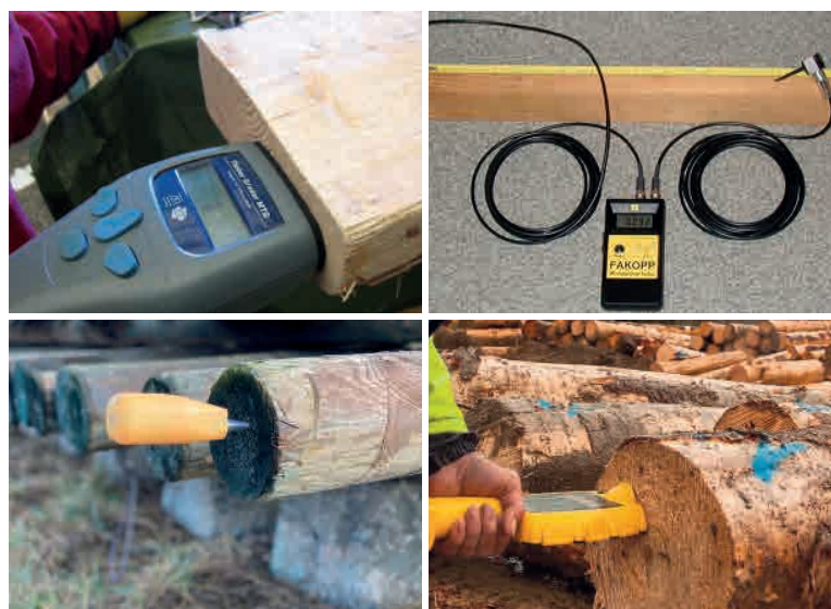
FIGURA 2. EQUIPOS MTG (IZQUIERDA ARRIBA), MICROSECONDTIMER (DERECHA ARRIBA), SYLVATEST (IZQUIERDA ABAJO) Y HM200 (DERECHA ABAJO). FUENTES: BROOKHUIS, FAKOPP, CBS-CBT Y FIBERGEN
