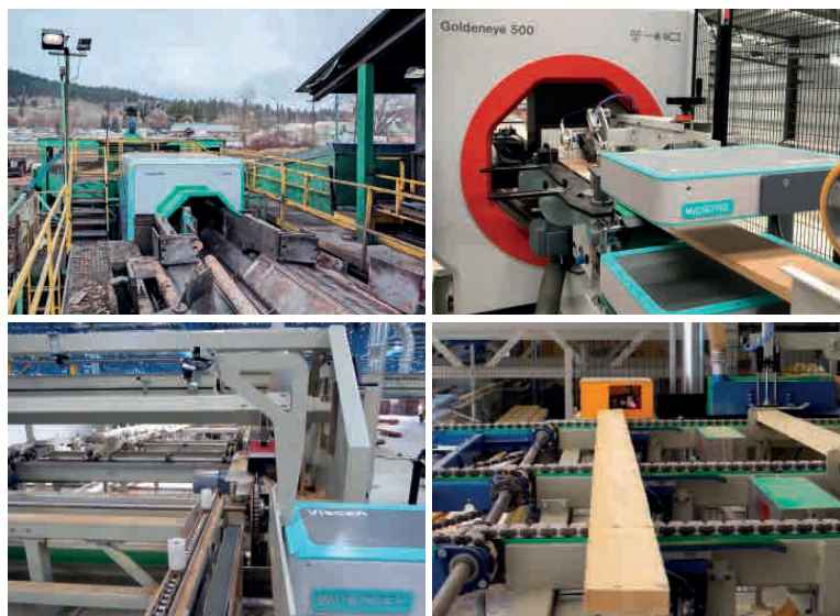
FIGURA 1. EQUIPOS LOGEYE (IZQUIERDA ARRIBA), GOLDENEYE (DERECHA ARRIBA), VISCAN (IZQUIERDA ABAJO) Y MTGBATCH (DERECHA ABAJO). FUENTE: MICROTEC Y BROOKHUIS
